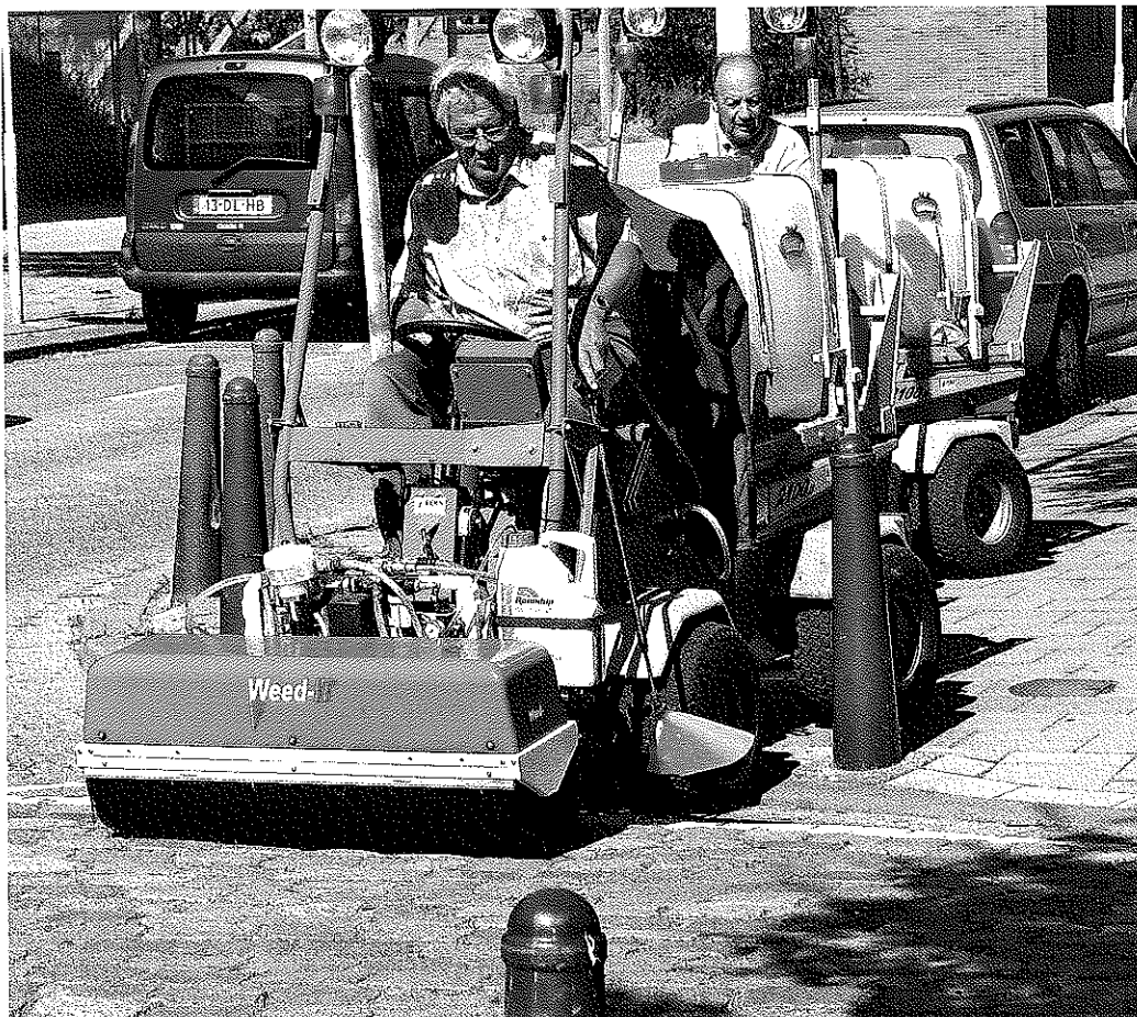
De Weed-IT MKII heeft sensoren onder de machine die het onkruid detecteren.
